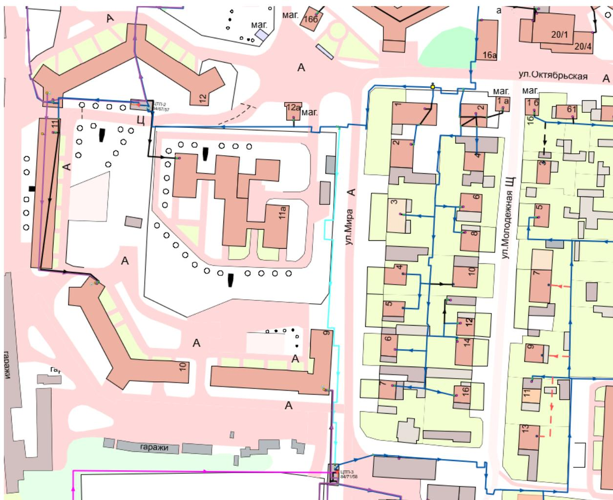
**Рисунок 18. Реконструкция трубопровода с увеличением диаметра от существующего ЦТП № 3**
